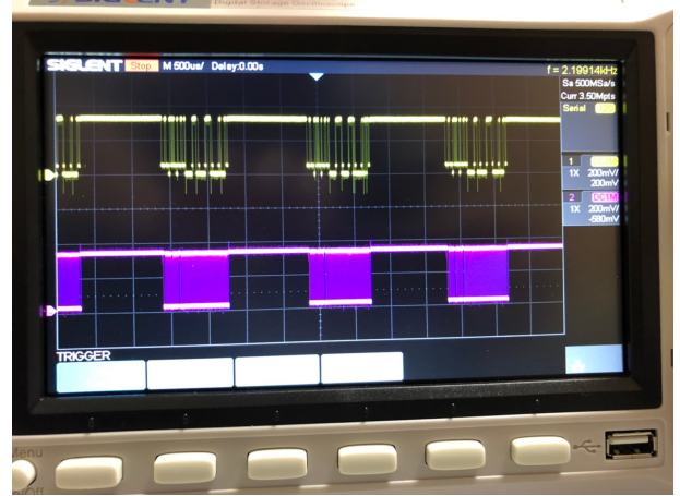
図 3: 上:SDA 信号 下:SCL 信号
