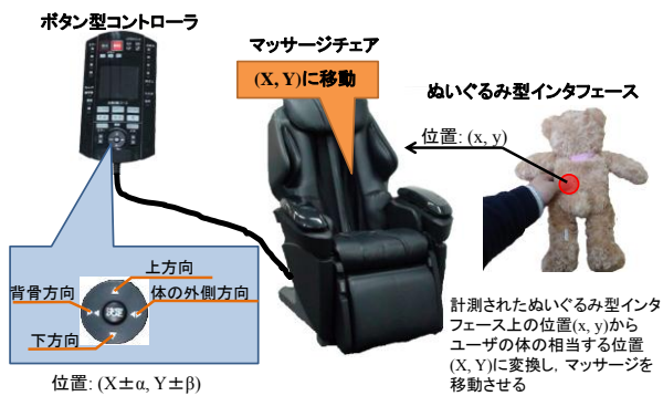
図 2: 本マッサージシステムの構成
