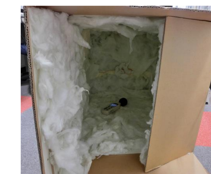
二重構造ダンボール箱の内壁にグラスファイバーを貼り付け作成
